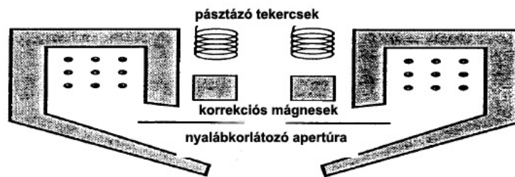
6.18. ábra Az objektív lencse a pásztázó tekercsekkel, korrekciós mágnesekkel és az apertúrával
