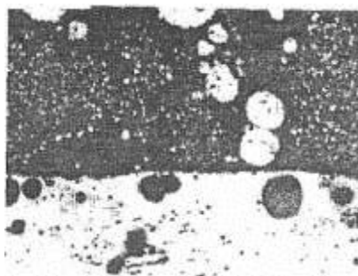
3.10. ábra Ólom–Cink ötvözet két olvadékrétegének határa. Világos: ólom, sötét: cink
