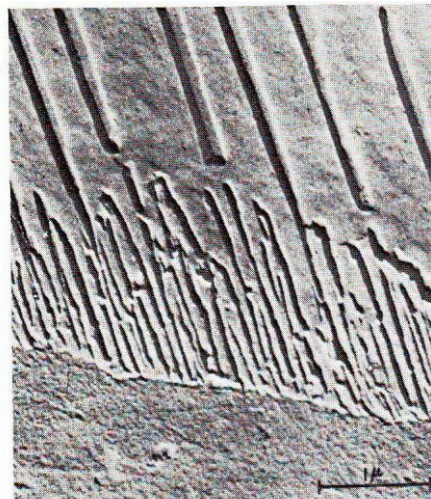
6.5. ábra Különböző hűtési sebesség hatására kialakult eltérő diszperzitású perlites szövetrész
